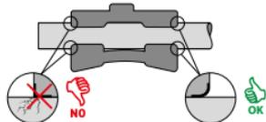
3. le ganasce devono avere la stessa forma della superficie esterna del telaio sella in modo da avere un buon accoppiamento con un'ampia superficie di contatto.
