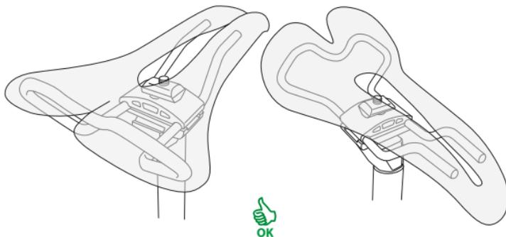
Tutti i modelli, ad esclusione dei modelli Martin e E-Bike, possono essere installati sulla bicicletta anche utilizzando un morsetto reggisella. In questo caso si raccomanda che il morsetto utilizzato sia del tipo a 5 componenti e con le caratteristiche di sicurezza evidenziate dalle figure seguenti. In caso di dubbi o ulteriori chiarimenti rivolgersi a Selle SMP:
