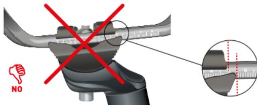
7. le ganasce non devono causare deformazioni o danneggiamenti al telaio sella
