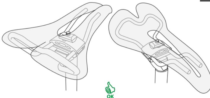
Todos los modelos, excepto los modelos Martin y E-Bike, se pueden instalar en la bicicleta, incluso con una abrazadera en la tija del sillín. En este caso se recomienda que la abrazadera sea del tipo de 5 componentes y con las características de seguridad que muestran las siguientes figuras. En caso de dudas o más información, póngase en contacto con Selle SMP:
