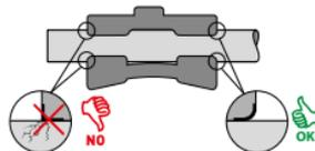
3. las mordazas deben tener la misma forma de la superficie exterior del cuadro, de manera tal de lograr un buen acoplamiento con una amplia superficie de contacto.
