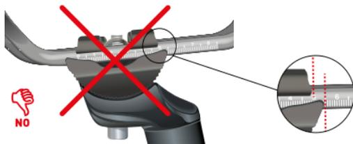
7. les mâchoires ne doivent pas provoquer de déformations ou d'endommagements au cadre de la selle.
